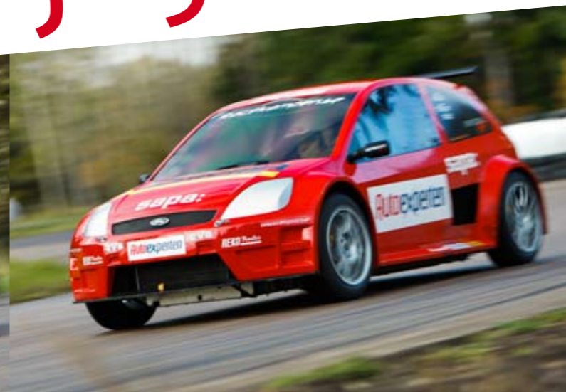
Med ungefär 650 kilo inklusive förare blir explosiviteten av sällan skådat slag, inte minst när den 185 hästar starka motorcykelmotorn varvas mot 10 000 r/min.
